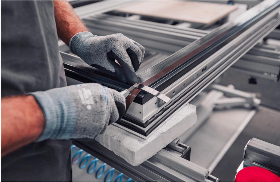
Als Metallbauer m/w/d Fachrichtung Konstruktionstechnik stellt man Metallkonstruktionen her. Dazu werden Profile und Bauteile maschinell bearbeitet und Teile durch Schraub- und Nietverbindungen zusammengesetzt. Die fertigen Konstruktionen werden geprüft und gemessen und anschließend montiert.
